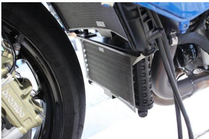
オイルクーラープロテクターを前工程で外したボルト2本とクリップ1個で取り付けます
