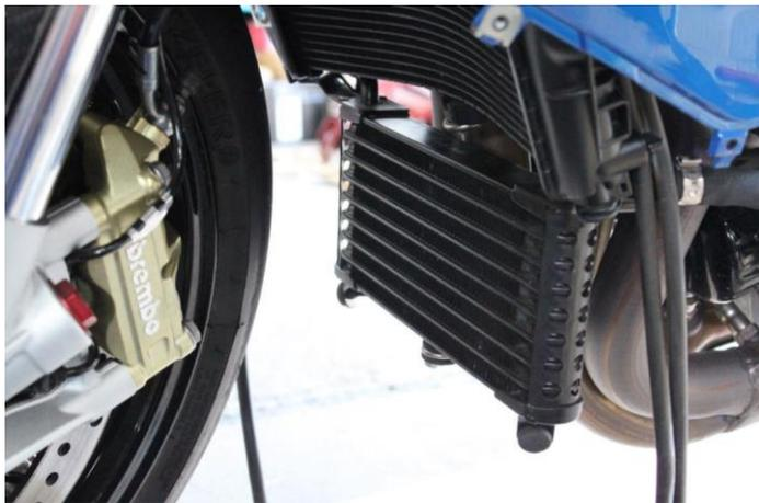
オイルクーラー本体上部左右のボルト2本と、下部中央クリップ1個を取り外します
