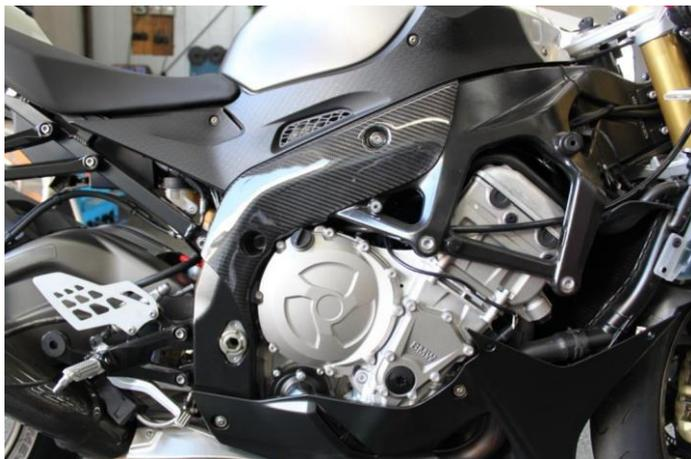
フレームヒートガードを貼り、前工程の赤い丸印の箇所に付属のカラーをノーマルのボルトで取り付けます
