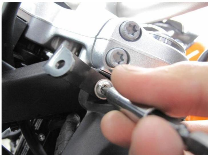
ブラケット（A・B）を前工程で取り外したボルト①で写真のように仮止めしてください
