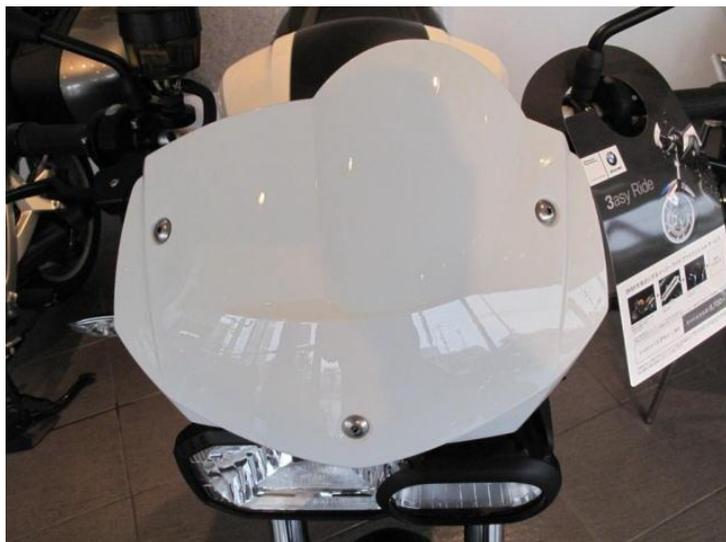
ボルト3本を外し、純正フロントカウルを取り外します
