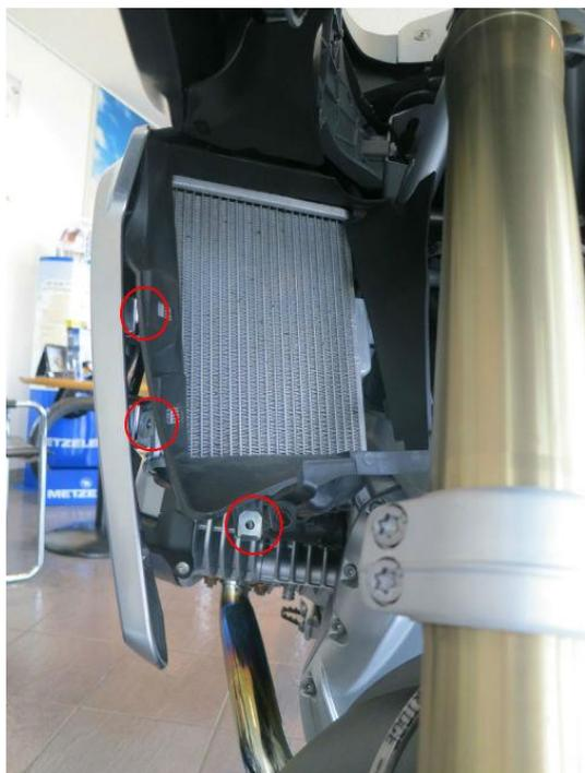
3箇所のボルトを外し、黒いカバーを外します
