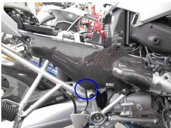
プロテクターRHの写真の箇所（青い丸印）がブレーキホースと干渉する場合は、ゴムラバー（B）をプロテクターに接着剤で取り付けてください
