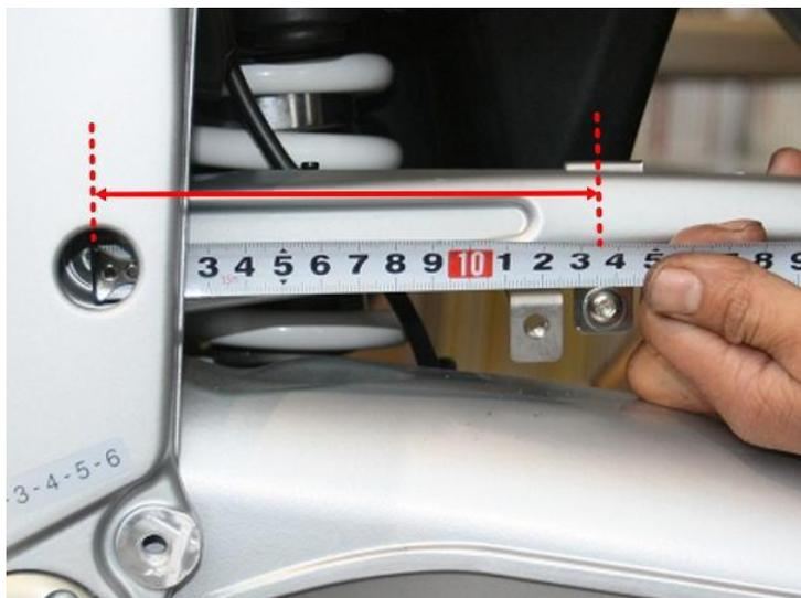
トルクロッド前側取付ボルトの中心を基点としてステー①（I）の中心が135mm程度になるようにセットしてください
