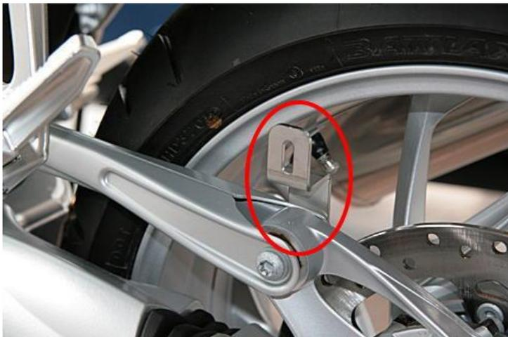
トルクロッドリアボルトのナットを外して、カラー（G）を入れてステー（A）を挟み込み、外したナットで取り付けます
