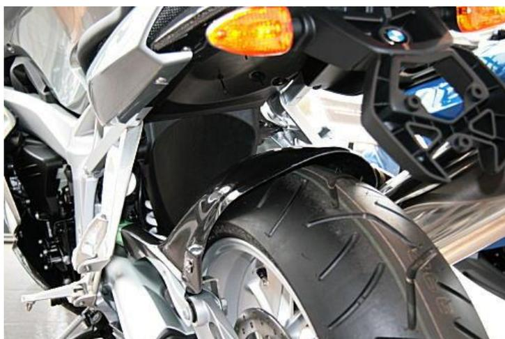
以上でリアフェンダーの取付けは終了です。試走後、再度タイヤとのクリアランスの確認をしてください。
