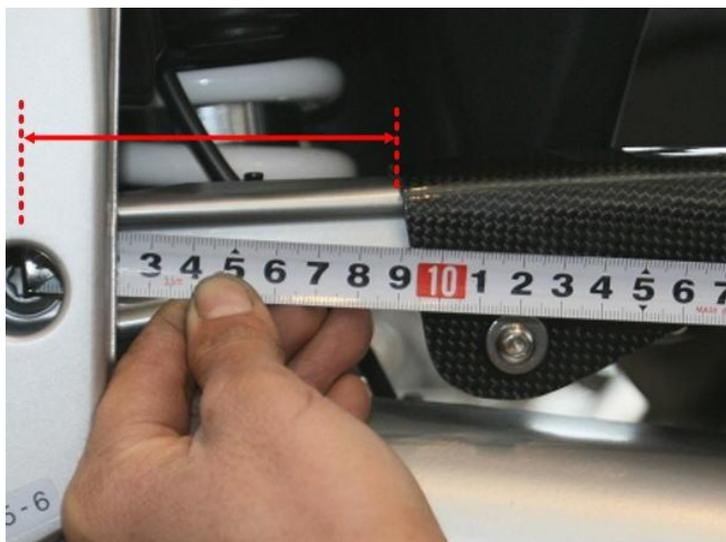
トルクロッド前側取付ボルトの中心を基点として各取付ステーの位置を仮決めします
