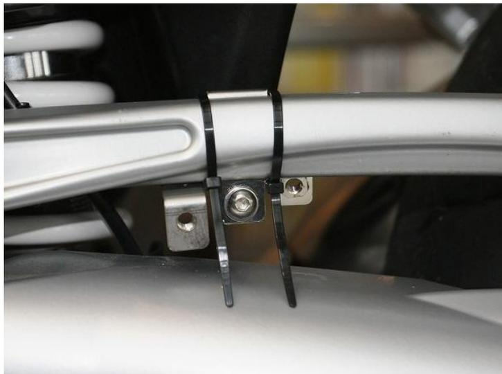
取付位置の調整後、再度ステー②（J）を写真のようにタイラップ（H）でしっかり締め付けてください
