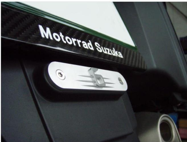
写真の位置へ付属のボルトとナットで取り付けてください。
