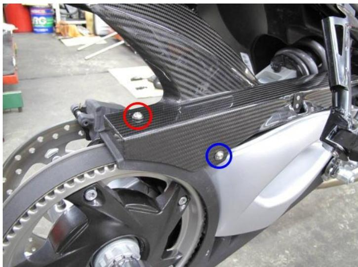
リアフェンダー側面（青い丸印）にボルト（F）とステンワッシャー（C）と樹脂ワッシャー（H）で取り付けます
