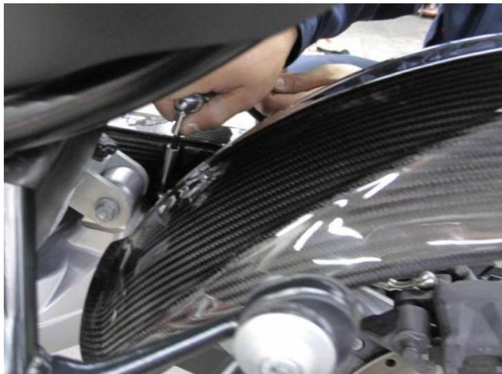
純正ベルトカバーを取り外した際のボルト①の穴にボルト（F）とステンワッシャー（C）と樹脂ワッシャー（H）でリアフェンダー本体を止めてください
