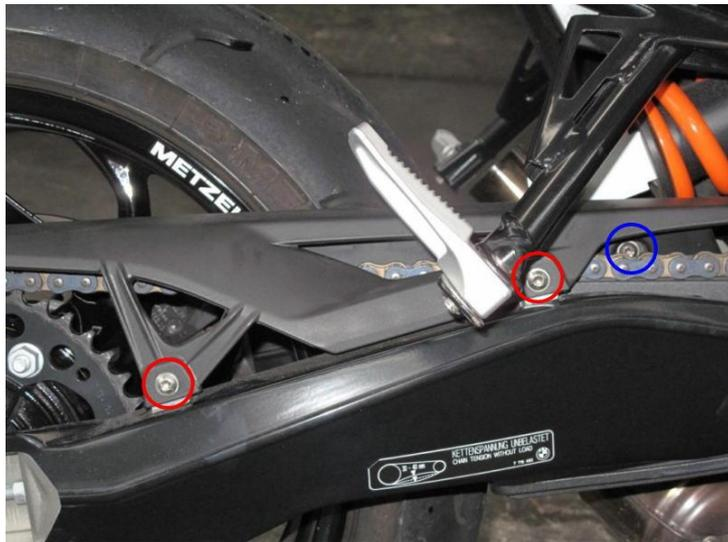
赤い丸印2箇所のボルトを取り外し、青い丸印のボルトをゆるめます
