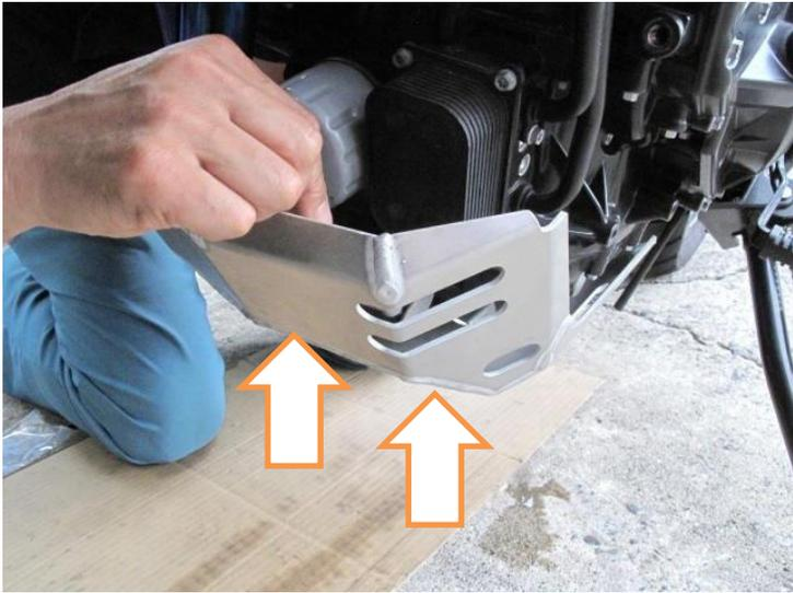
車体に組み付けてから本締めします
