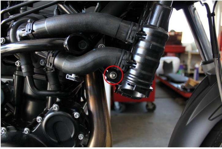
ボルトを外し、ラジエターを車両右側へずらし
