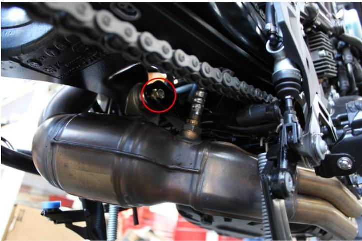
ボルトを外し、O2センサーを取り外します
