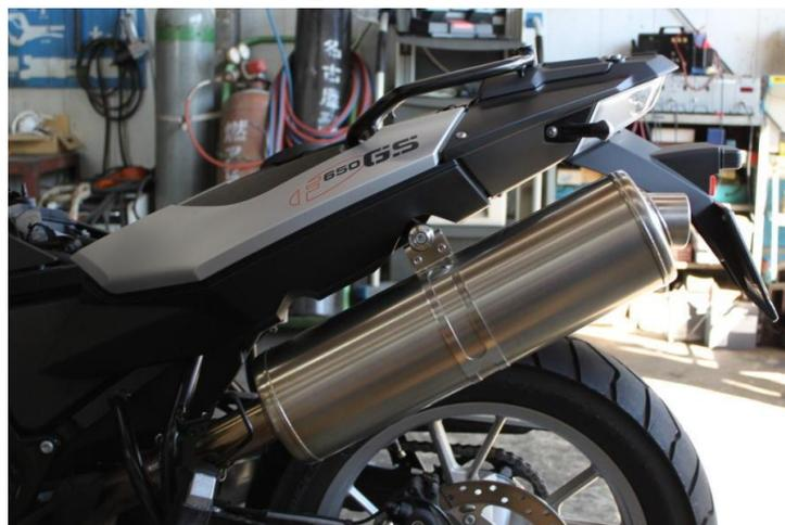
スプリング2本とボルト1本を外し、ノーマルマフラーを車両後方へ引き抜きます
