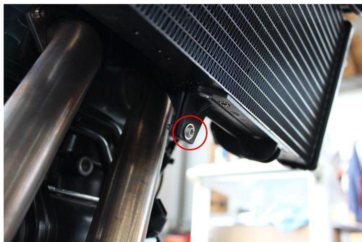
ラジエター下部のボルトを外します
